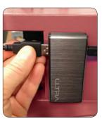
5. Connect the Hub USB mini cable to the Hub.
